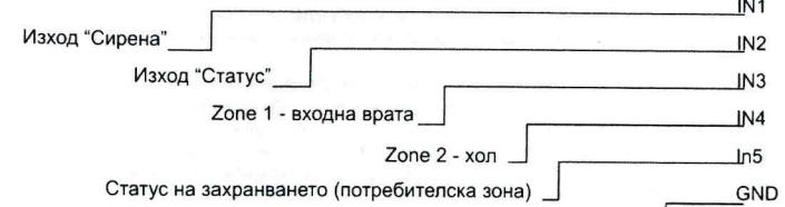
Показаната примерна схема на свързване към домашна охранителна система е със следното значение:
